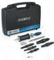
SHX-1 滑桿式培林拆卸工具是一種專業工具，專門設計於從自行車上拆下培林。利用可伸縮的夾頭與軸，及堅固的滑桿 (960g)，SHX-1 安全而有力地針對性衝擊力能推出培林。HX-1 兼容內徑為 6 到 32 毫米的盒式培林，能和自行車上大多數的壓入式部件配合使用，包括輪組，車架連桿和底部支架。
