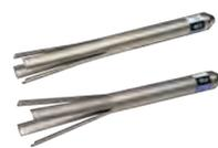
Park Tool 頭碗組珠碗座拆卸工具讓頭碗組的拆卸工作變得更容易了。經由頭管將工具拉出，直到外擴的末端抵住頭碗碗槽基座內側。從工具的頭部敲打即可卸下頭碗座。此工具是以強化熱處理合金鋼製成，加上鍍銀表面處理。
