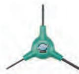
TWS-3 為 Torx® 相容的三向星型扳手。T10、T25 和 T30 三向星型扳手尺寸為我們 Y 型設計經典款。用於碟盤螺栓 (T25)、齒盤 (T30)、液壓碟煞 (T10)。
