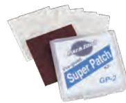
Park Tool 有史以來最成功的產品之一！與 3M® 公司合作，生產出這種自黏式內胎補片，具有和內胎共同拉伸、彎曲、扭轉的特性。再也不需要黏答答的胎膠和體積龐大的補修包。用內附的砂紙稍微打磨內胎表面並貼上補胎片，就可以再度上路了。小巧的攜帶盒內有六塊補胎片和砂紙。有獨立吊卡式包裝 (GP-2C) 或是方便的 48 盒為展示盒方式販售。
